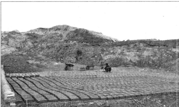
تصویر شماره ۱۵: فضای کارگاه خشت زنی و ردیفهای خشت قالب گیری شده
